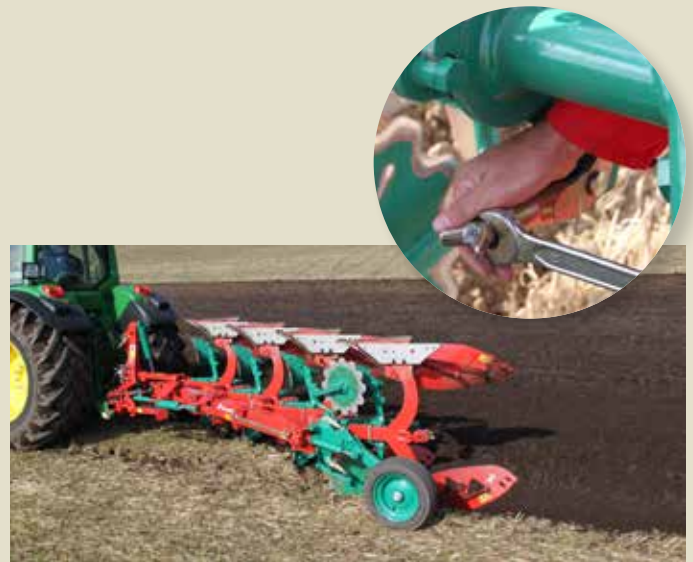
Einfache und schnelle Einstellung der Arbeitstiefe mit Y-Schrauben
