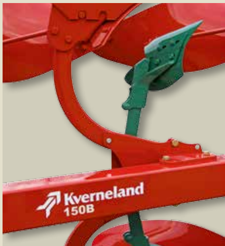
Leichtes und stabiles Hohlgrindel mit Scherbolzensicherung
