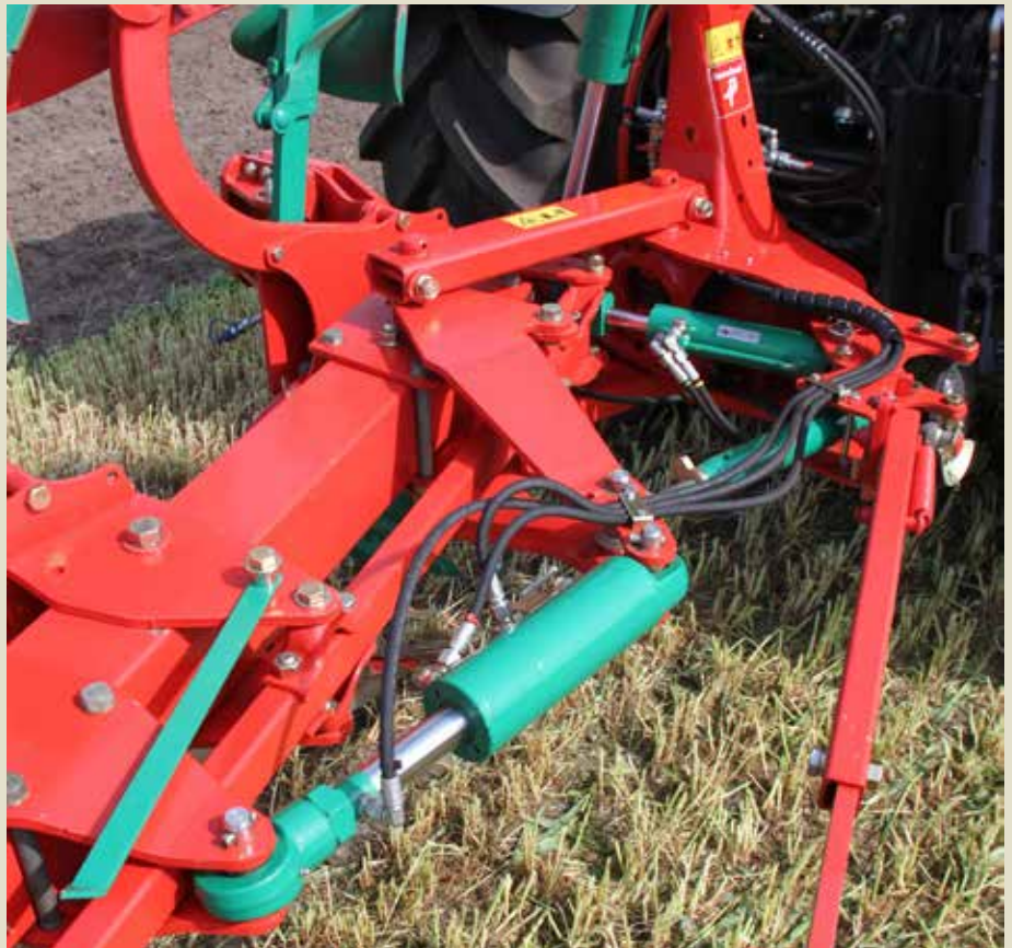
Parallelogrammführung mit Memoryzylinder und hydraulischer Einstellung der Vorderfurche.
