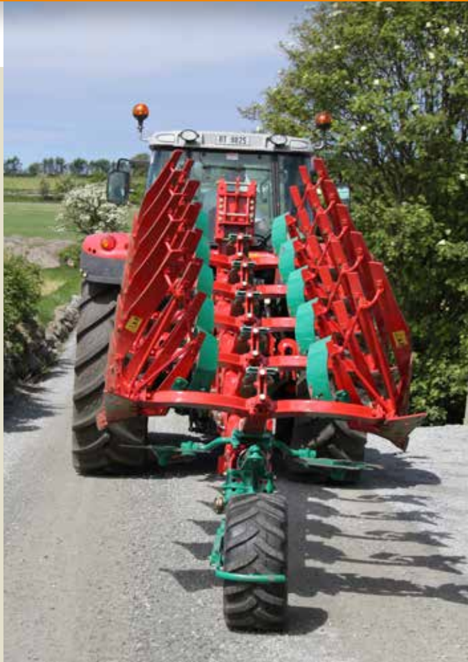
Transportstellung: Hinten angebautes Stütz- und Transportrad
