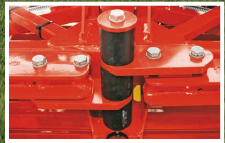
Zentraldämpfung der Ausleger für schnellste Beruhigung und eine stabile Gestängelage.
